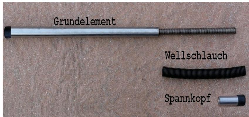
Die Sicherheitsklemmstange ist auf die max. Länge voreingestellt. Zur Montage muss sie auf die benötigte Länge gekürzt werden. Dazu wird der Wellenschlauch gekürzt.
